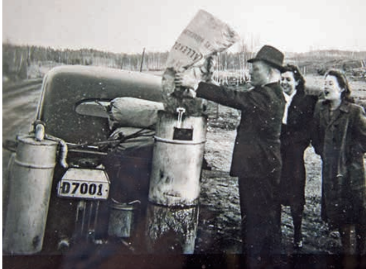
Precis som vilken eldstad som helst måste gengasaggregaten slaggas ur och sotas med regelbundna mellanrum.
