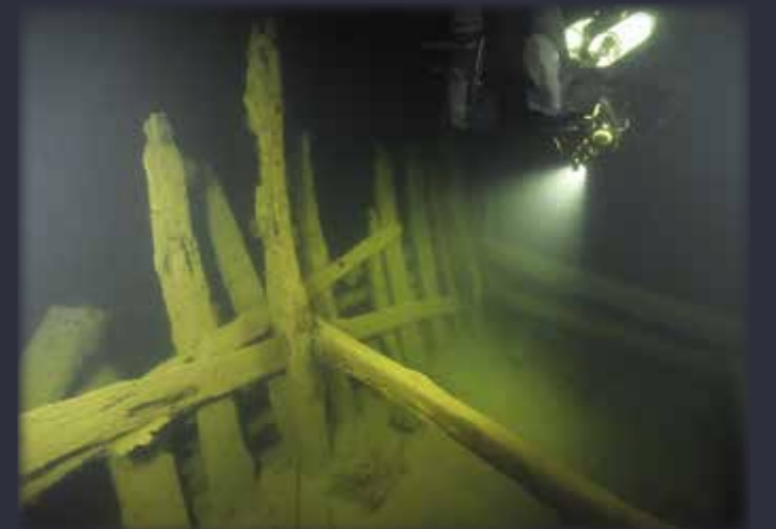
Borden är kraftigt eroderade men spanten är intakta. Foto: Jim Hansson.
